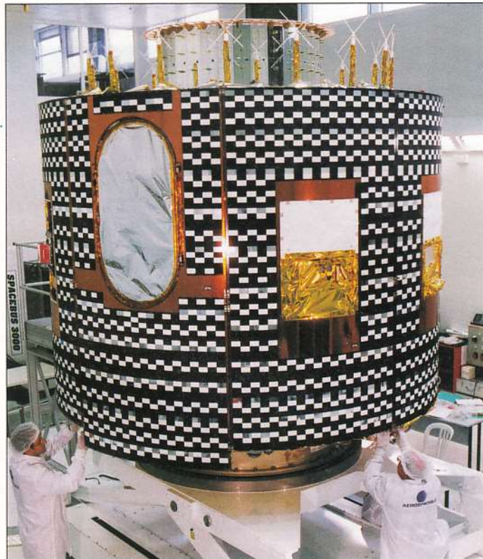
Links: De zonnepanelen zijn nog niet aangebracht. Daarvoor in de plaats een warmte-testlaag. Rechts: MSG-1 in aanbouw bij Aérospatiale in Zuid-Frankrijk.
